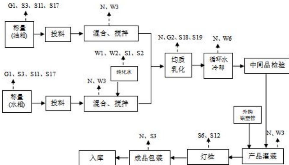
图 2.2-10 103 车间 FDA 软膏产品生产工艺流程图
