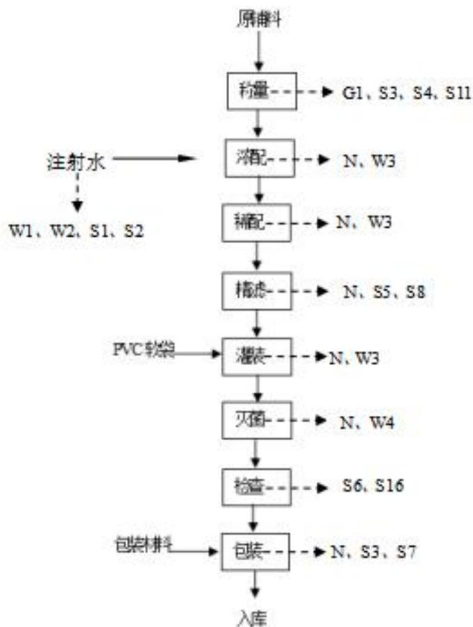
图 2.2-14 105 车间大输液车间 PVC 软袋腹膜透析液生产线工艺流程图
