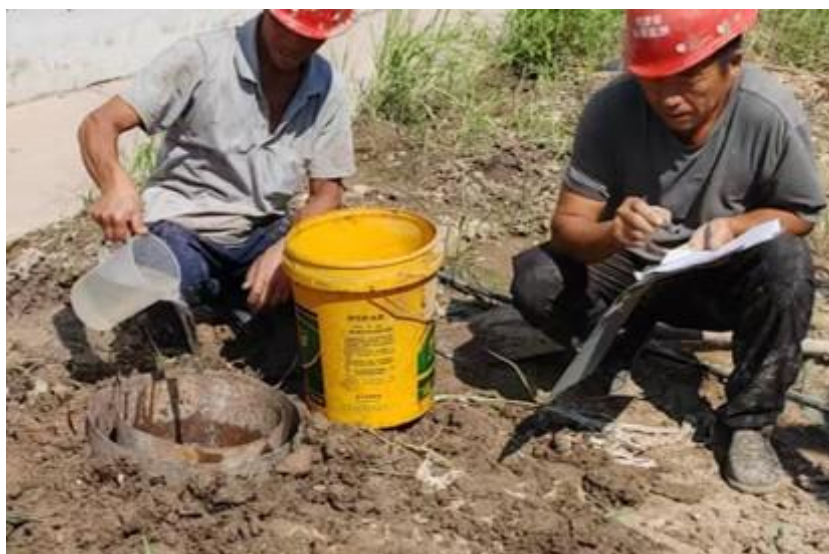
图 3.2-4 渗水实验照片
