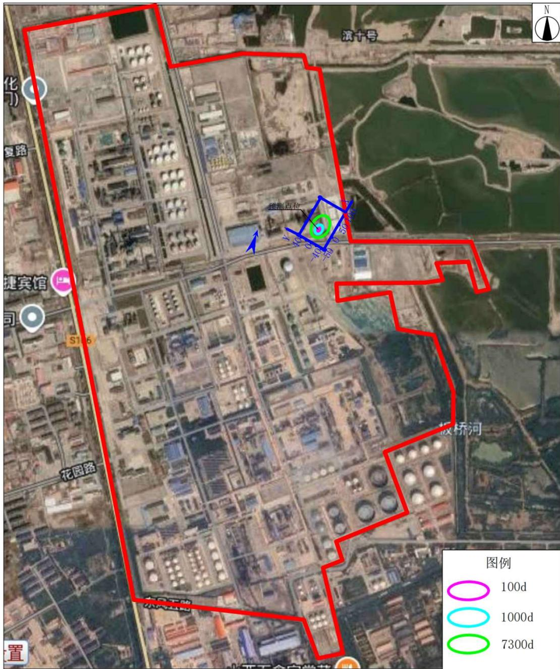
图 6.5 污水处理站污水预处理池非正常状况泄漏后石油类影响范围预测图
