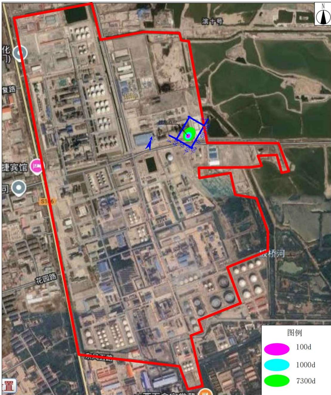
图 6.4 污水处理站污水预处理池非正常状况泄漏后石油类超标范围预测图
