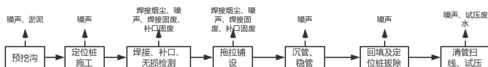
图 4-13 大开挖沉管工艺流程及产污节点示意图
