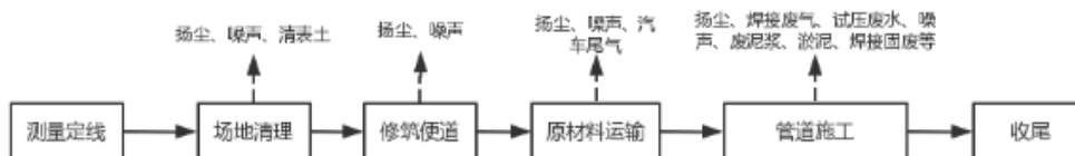
图 4-10 改线管道敷设工艺流程及产污节点示意图
