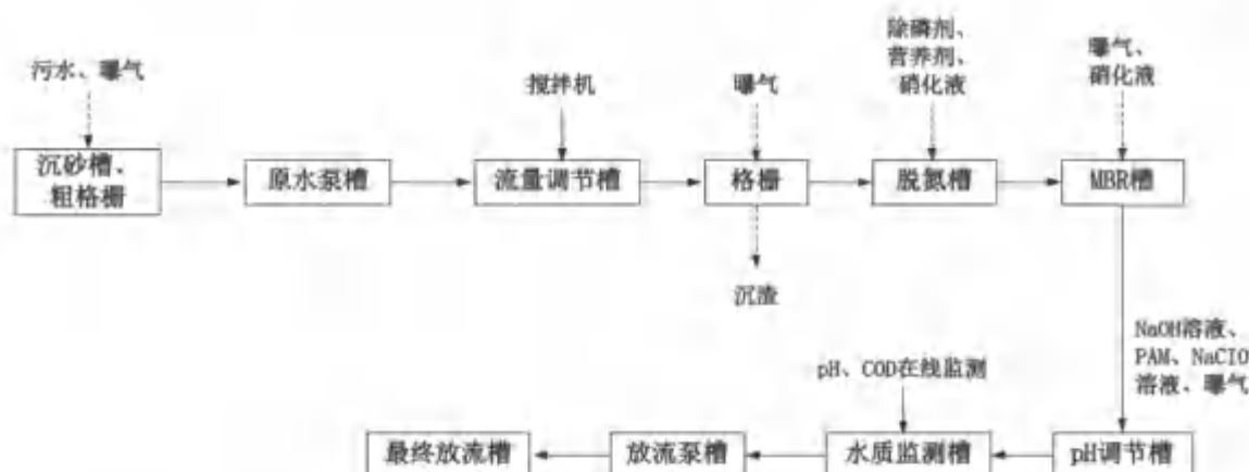
图 8.4-1 厂内现有污水处理站工艺流程
