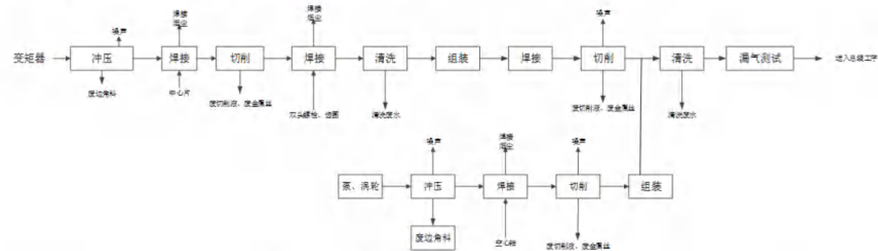
图 3.4-4 变矩器加工生产线工艺流程及产污节点图
